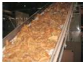
Transport wilgotnych liści przez gorącą parę na taśmociągach pochylonych. POLER 18T1F jest idealny dzięki odporności na ścieranie i wysokie temperatury.
